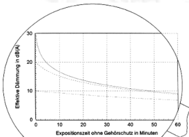
Bild 8: Effektive Dämmung eines Gehörschützers in Abhängigkeit von der Expositionszeit ohne Gehörschützer bezogen auf eine 8-Stunden-Schicht
