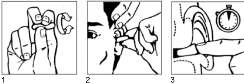
Bild 9: Einsetzen von Gehörschutzstöpseln (Quelle: Howard Leight)
